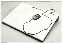
Il digitizer Watanabe Mitabets DT1000. La superficie è inclinata di qualche grado, la dimensione dell'area lavorata all'input è di 380 per 280 millimetri.
